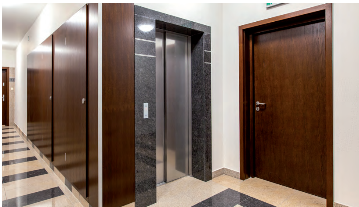
drzwi AKUSTIK 32dB III klasa mechaniczna jednoskrzydłowe, ościeżnica regulowana drewniana
