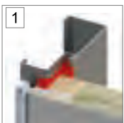
1 Wypełnienie skrzydła PŁYTA SKALNEJ WEŁNY MINERALNEJ
