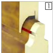
Ocieplony panel (grubość 45 mm)
