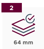
2 Skrzydło drzwiowe z uszczelką, wielowarstwowym wkładem oraz ramiakiem z drewna klejonego 64 mm
