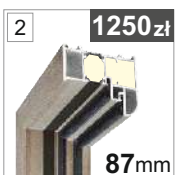
Ościeżnica aluminiowa ALU/90 trzykomorowa z podwójnym uszczelnieniem z przegrodą PCW wypełniona pianą
