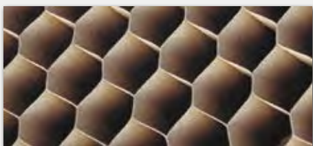
(A) Wkład stabilizujący „plaster miodu”
