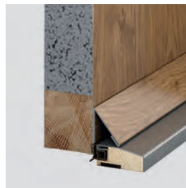
Wypełnienie – ekspandowany polistyren
